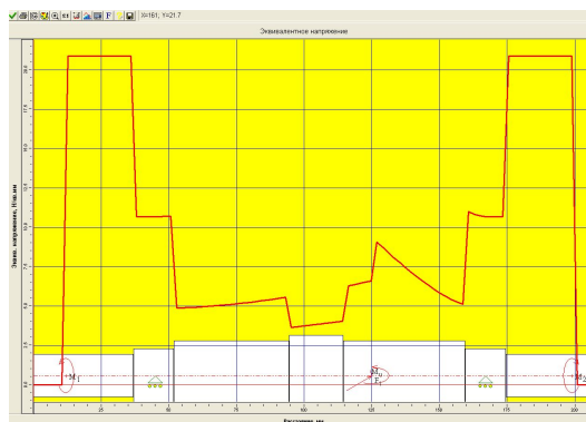
Рис. 3: Напряжения, испытываемые промежуточным валом при работе
