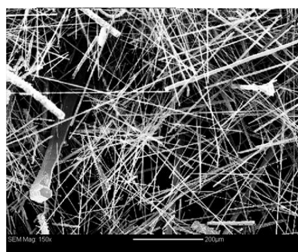
Рис.2 Нитевидные кристаллы \text{SnO}_2 , допированные Sb
